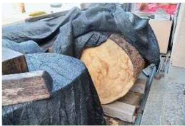
材料の桐は乾燥しすぎないように寒冷紗をかけて保管している
