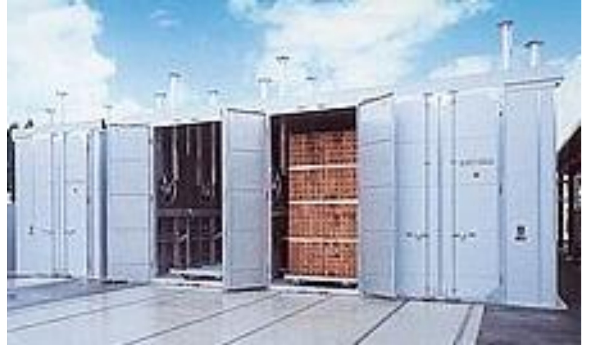
ヒルデブランド (株) 蒸気式中温乾燥機 HD78/KSR130
